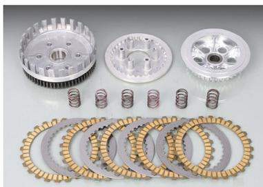
ノーマルクラッチのディスク数を増やす事でクラッチ容量が向上。滑りを抑制し、耐久性を向上させます。専用のアウターやスプリングも付属のアッセンブリーKIT。
